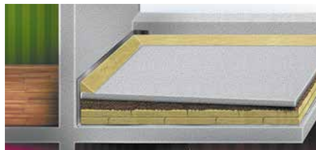
Рис. 7.7. Заведение пароизоляционного слоя на примыканиях к стенам эксплуатируемых помещений
