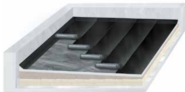
Рис. 7.17. 1 — Укладка материала перпендикулярно уклону при уклоне основания менее 15%;
