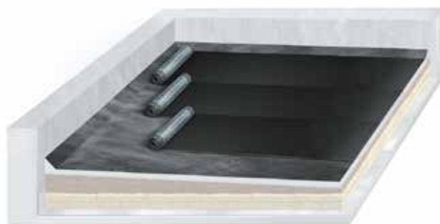
Рис. 7.17. 1 — Укладка материала перпендикулярно уклону при уклоне основания менее 15%;
