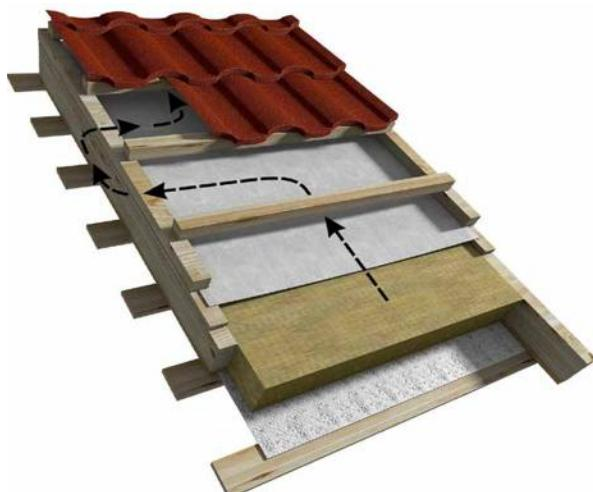
Рис. 6. Строение кровельной системы ТН-ЛЮКСАРД Мансарда.
