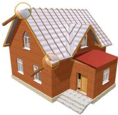
Рис. 1.128. Укладка ветро-, влагозащитного материала
