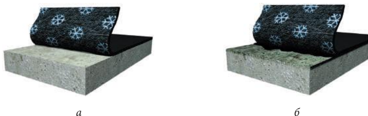
Рис. 1.31. Поверхность основания: а — негрунтованная; б — обработанная грунтовкой
