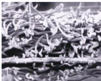
Рис. 1.21. Трехслойная супердиффузионная мембрана
