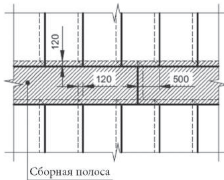
Рис. 5.37. Устройство однослойного гидроизоляционного покрытия методом сборной полосы
