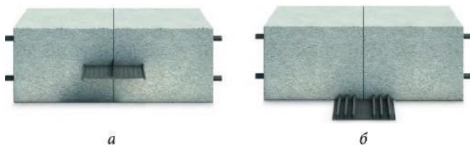
Рис. 5.7. Гидрошпонки для технологических швов: а — центральная гидрошпонка; б — боковая гидрошпонка
