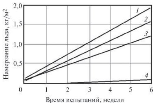
Рис. 1.18. Результаты испытаний намерзания льда при Sd : 1 — 2,0 м; 2 — 0,13 м; 3 — 0,04 м; 4 — 0,02 м
