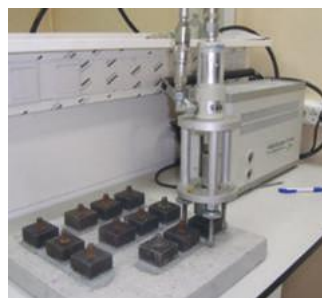
Рис. 2.3. Определение прочности сцепления раствора с основанием
