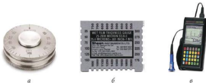
Рис. 5.53. Приборы для измерения толщины слоя мастики: а — диск; б — гребенка; в — толщиномер
