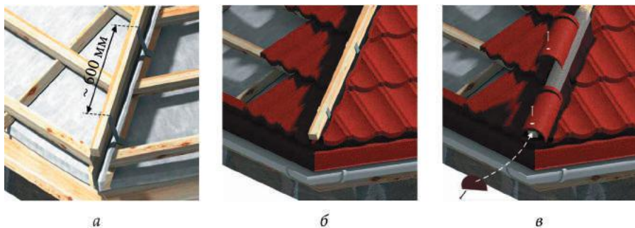
Рис. 1.163. Устройство ребра: а — крепление конькового бруса; б — подрезка панелей; в — крепление коньковых элементов
