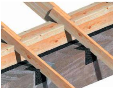
Рис. 1.147. Соединение элементов каркаса с использованием битумной гидроизоляции
