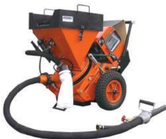
Рис. 5.58. Торкрет-установка SSB 14 и ее характеристики: производительность 0,5—3,0 м 3 /ч, давление воздуха 0,5—0,6 МПа; расстояние подачи до 300 м по горизонтали и до 100 м по вертикали
