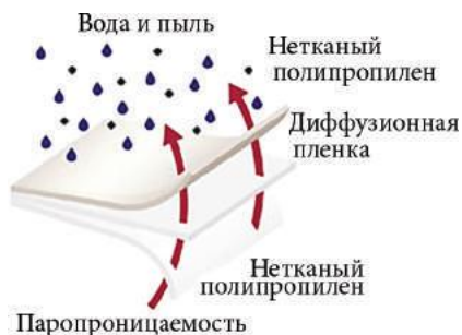
Рис. 1.22. Принцип работы супердиффузионной мембраны
