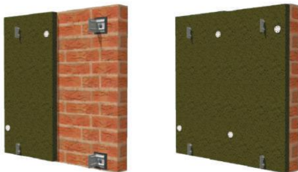
Рис. 2.45. Монтаж теплоизоляционных плит
