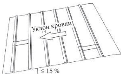
Рис. 1.62. Укладка материала на скате крыши перпендикулярно уклону
