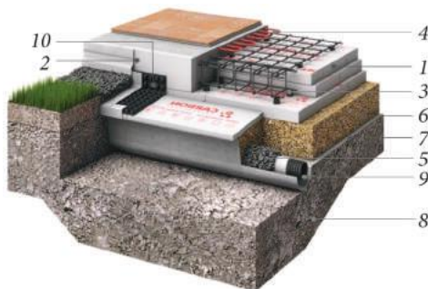
Рис. 5.115. Малозаглубленный фундамент «Утепленная шведская плита»: 1 — XPS плиты ТЕХНОНИКОЛЬ CARBON ECO SP; 2 — бетонная конструкция фундамента; 3 — арматура; 4 — система водяного обогрева пола; 5 — гравийная обсыпка; 6 — песчано-гравийная подготовка; 7 — геотекстиль; 8 — грунт основания; 9 — дренажная труба; 10 — профилированная мембрана PLANTER
