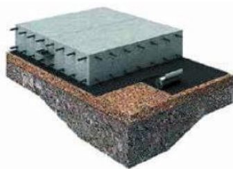
Рис. 5.93. Замена бетонной подготовки профилированной мембраной PLANTER standard
