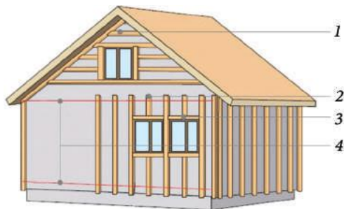
Рис. 2.51. Установка обрешетки под фасадные панели: 1 — горизонтальные рейки под вертикальный монтаж сайдинга; 2 — вертикальные рейки под горизонтальный монтаж сайдинга; 3 — обрешетка вокруг окон; 4 — разметочный шнур
