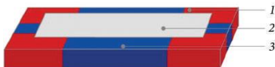
Рис. 1.76. Условное деление кровли для расчета количества крепежных элементов: 1 — угловая зона; 2 — центральная зона; 3 — парапетная зона
