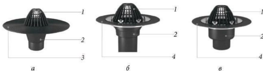
Рис. 1.102. Кровельные воронки ТехноНИКОЛЬ : а — с листвоуловителем и фланцем из кровельного материала (ВБ); б — с листвоуловителем и прижимным фланцем из нержавеющей стали (ВФ); в — обогреваемая с листвоуловителем и прижимным фланцем из нержавеющей стали (ВФО); 1 — листвоуловитель; 2 — корпус воронки; 3 — фланец воронки; 4 — прижимной фланец
