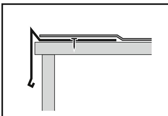
Фронтонный свес кровли усиливается металлическими торцевыми планками, которые крепятся специальными кровельными гвоздями в шахматном порядке с шагом 120–150 мм, а в местах нахлеста – 20–30 мм. Место нахлеста Рулонной черепицы ТЕХНОНИКОЛЬ на торцевые планки дополнительно промазывается мастикой ФИКСЕР.
