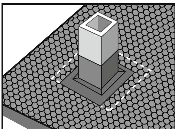
Полученные выкройкигибаются или надрезаются в определенных местах. Первоначально монтируется лицевая выкройка. Затем монтируется левая и правая выкройки. В последнюю очередь монтируется тыльная выкройка. При монтаже необходимо соблюдать принцип каскадности воды. Места сопряжения следуют проклеить битумной мастикой ФИКСЕР на величину 100 мм.
