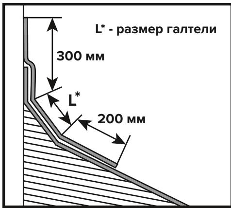
Для заведения на вертикальную поверхность используют Коньково-Ендовный ковер для Рулонной Черепицы. Выкройки для заведения наверх следует укладывать внахлест не менее 200 мм на поверхность покрытия и с минимальным нахлестом 300 мм на заводимую поверхность. Размер галтели уточнить по месту.
