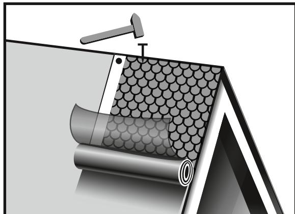
Перед началом монтажа необходимо очистить основание от мусора и пыли. Для улучшения адгезии рекомендуется обработать поверхность любым грунтовочным составом. Примерить материал по месту, убедиться в правильной геометрии рисунка, частично снять защитную пленку и зафиксировать. Затем полностью вытянуть защитную пленку на себя, прижимая материал к основанию. При монтаже на первый скат Рулонная черепица ТЕХНОНИКОЛЬ укладывается на конек с дополнительной механической фиксацией поперечного края.
