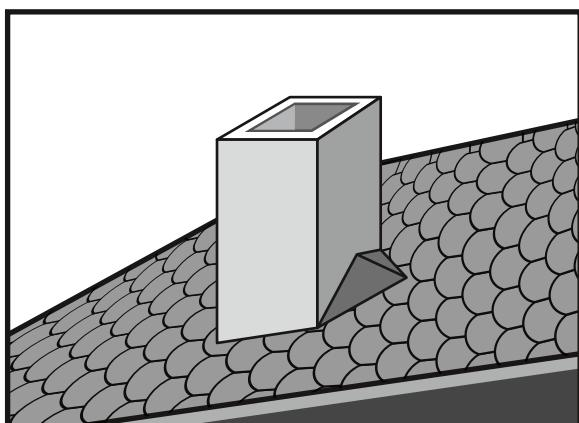
Для предотвращения скапливания снега за дымовыми и вентиляционными трубами, если их сечение превышает 500×500 мм и они расположены поперек ската, рекомендуется устанавливать разжелобок.
