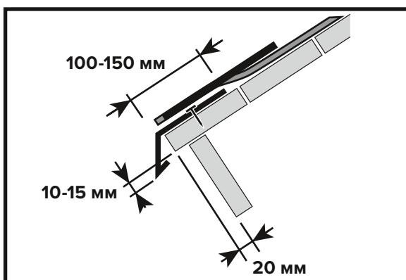
Карнизный свес кровли усиливается металлическими планками (капельниками). Они укладываются ребром на край сплошного основания и крепятся специальными кровельными гвоздями в шахматном порядке с шагом 120–150 мм, а в местах нахлестов 20–30 мм. Нахлест планок между собой составляет 30–50 мм.
