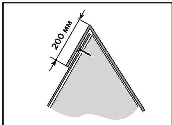
При монтаже второго ската Рулонная черепица ТЕХНОНИКОЛЬ переходит через конек, закрывая кровельные гвозди поперечного края первого ската не менее чем на 200 мм, и приклеивается с помощью битумной мастики ФИКСЕР.
