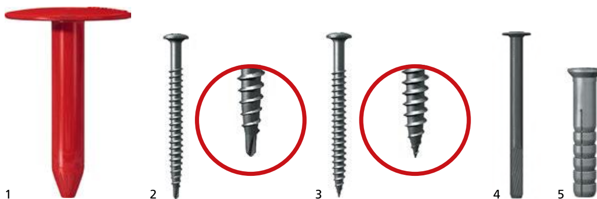
Рис. 3.40. Крепежные элементы при фиксации водоизоляционного ковра через теплоизоляционный слой 1 – Телескопический крепеж; 2 – Сверлоконечный саморез ТехноНИКОЛЬ диаметром 4,8 мм; 3 – Остроконечный винт ТехноНИКОЛЬ диаметром 4,8 мм; 4 – Стальной забивной анкер; 5 – Полиамидная анкерная гильза
