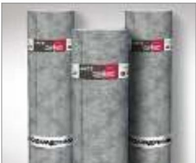
**— ANDEREP PROF** — легкий (всего  $0,5 \text{ кг}/\text{м}^2$ ) и прочный подкладочный материал с основой из полиэфира. Нескользящая поверхность из полипропилена (Spunbond) гарантирует защиту от УФ. Подкладочный ковер используется под любой тип кровельного покрытия, а также может служить временной кровлей при перерывах в работе.
