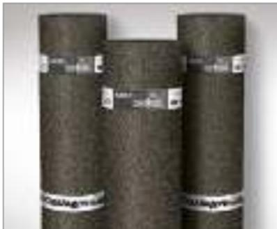
— **ANDEREP GL** — механически закрепляемый подкладочный ковер с основой из стеклохолста и двусторонней посыпкой мелкозернистым песком. Применяется в кровлях из гибкой черепицы.
