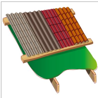
Классическая система с холодным чердаком по деревянным стропилам с покрытием крыши из штучных материалов (металлическая черепица, волнистые листы, композитная черепица, натуральная черепица). Под кровельное покрытие на стропила механически крепится подкладочный ковер ANDEREP PROF, который выполняет функцию дополнительной гидроизоляции.
